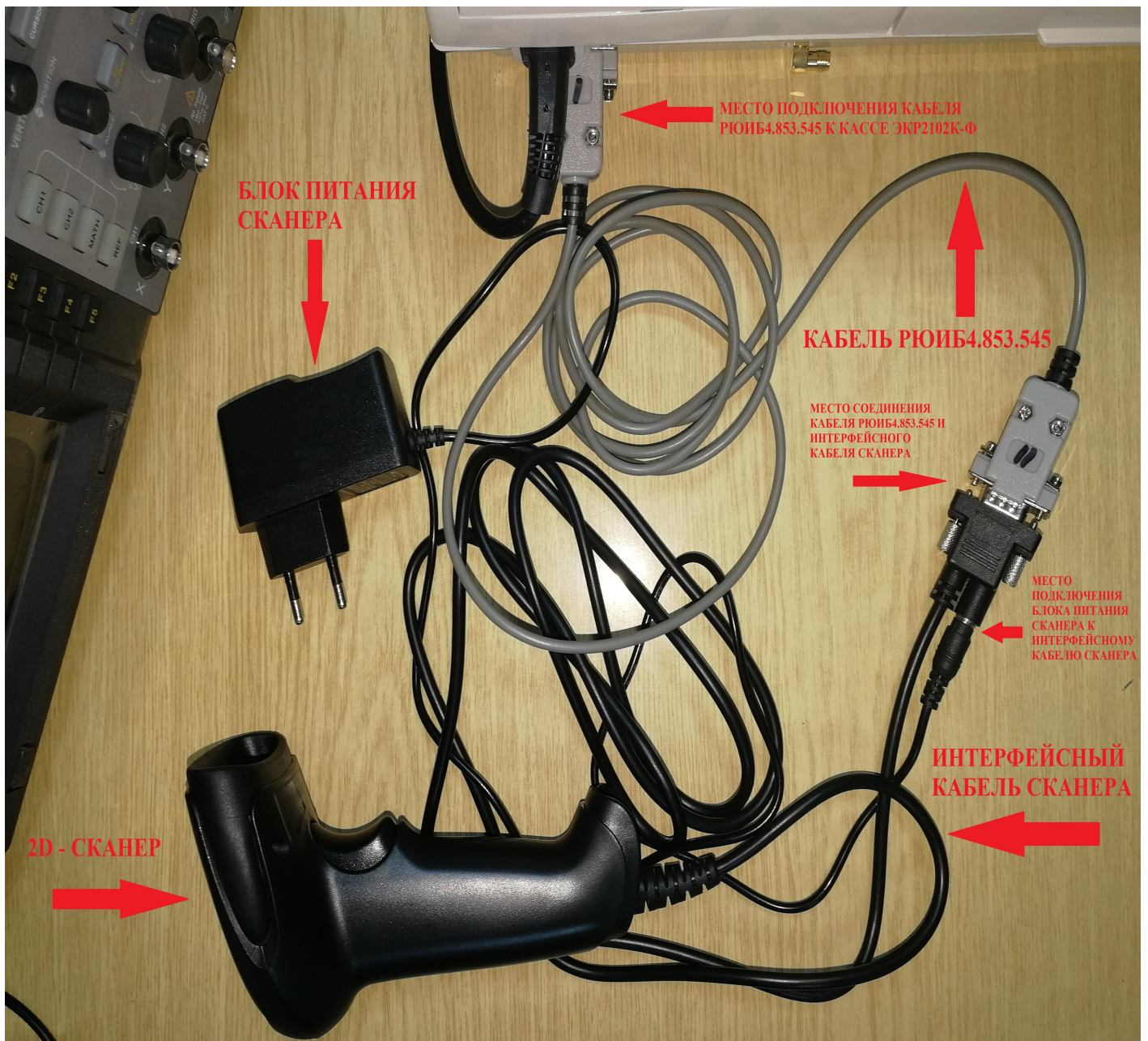
Рис.1 Подключение сканера к кассе ЭКР2102К-Ф
