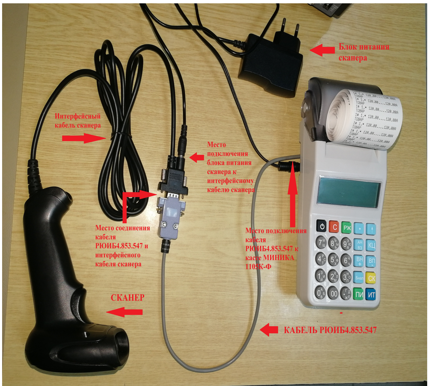
Рис.1 Подключение сканера к кассе МИНИКА 1105К-Ф
