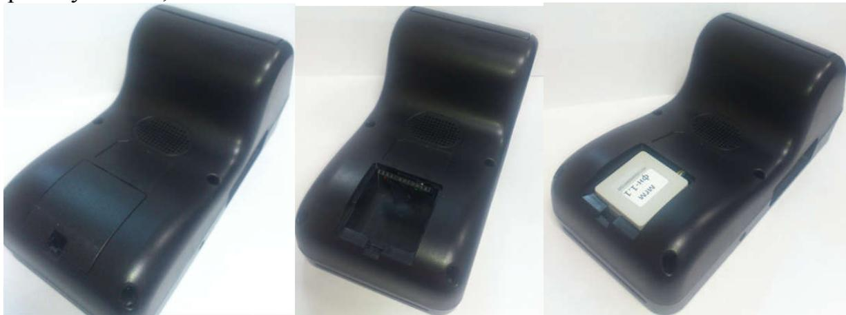
Рисунок 1 Отсек расположения фискального накопителя
